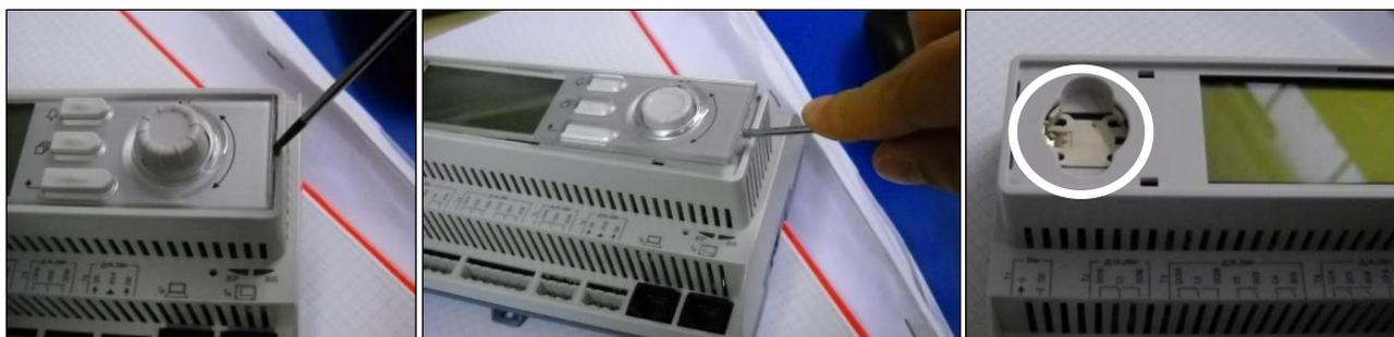
Veiller à ne pas endommager le couvercle. La nouvelle batterie peut être placée dans le support de batterie prévu à cet effet (surligné dans la photo ci-dessous) en respectant les polarités indiquées sur le support.
