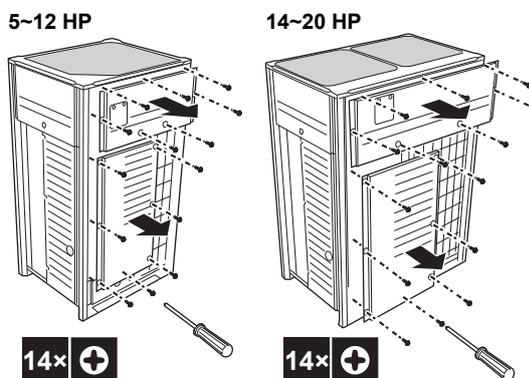
Une fois que les plaques avant sont ouvertes, il est possible d'accéder au coffret électrique. Voir "14.2.2 Pour ouvrir le coffret électrique de l'unité extérieure" [p 29].
