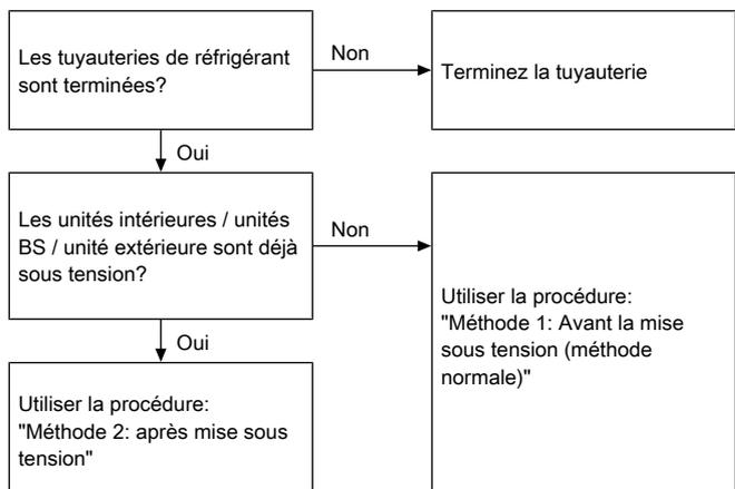
Il est très important que toute la tuyauterie de réfrigérant soit réalisée avant que les unités (extérieure, BS ou intérieure) soient mises sous tension. Lorsque les unités seront mises sous tension, les vannes d'expansion s'activeront. Cela veut dire que les vannes se fermeront.
