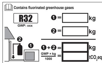
Charge totale = charge d'usine ①<sup>(a)</sup> + charge supplémentaire ②<sup>(b)</sup>
