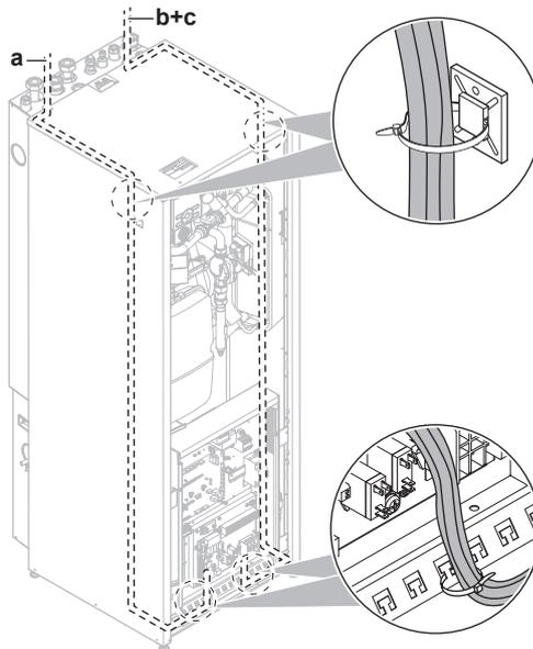
4 Fixez le câble avec des attaches sur les supports d'attaches pour garantir un relâchement de la contrainte et s'assurer qu'il n'entre PAS en contact avec la tuyauterie et avec des bords tranchants.
