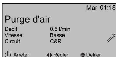
La fonction de purge d'air automatique s'arrête automatiquement au bout de 30 minutes, puis l'installateur doit redémarrer cette même fonction pour la zone de température secondaire. Cette fonction s'arrête également automatiquement au bout de 30 minutes.
