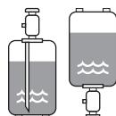
Charger le réfrigérant liquide avec le cylindre en position retournée.
