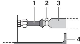
Utiliser de la bande ou du matériel isolant sur toutes les connexions pour éviter que l'air ne pénètre entre la tuyauterie de cuivre et la gaine d'isolation. Veiller à procéder de la sorte si l'unité extérieure est installée comme illustré.
