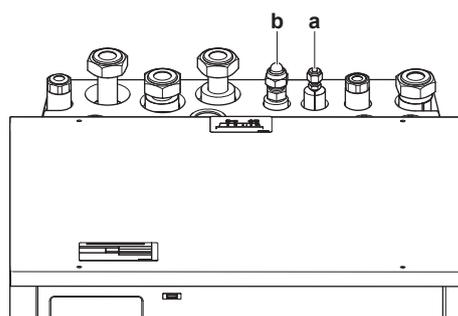
a Raccord du liquide réfrigérant
