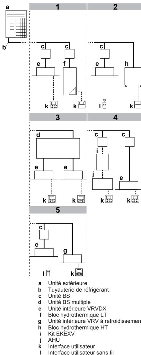
L'ensemble du système peut être divisé en plusieurs sous-systèmes. Ces sous-systèmes ont une indépendance à 100% en ce qui concerne la sélection du mode de refroidissement et de chauffage, et chacun consiste en une unité BS simple ou un jeu de branchements individuels d'une unité BS multiple, et toutes les unités intérieures connectées en aval. Lors de l'utilisation d'un sélecteur de refroidissement/chauffage, branchez-le à l'unité BS.
